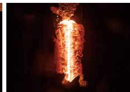
フラッシュバット溶接完了
